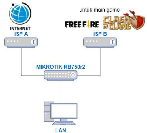
Gambar 3. Rancangan Topologi PBR Berdasarkan Port
